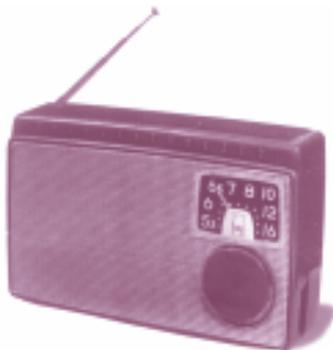
件。1945 年美国的利金斯公司开发了使用晶体管的无线电。第二年日本的索尼公司，便应用了这项技术。由于晶体管的出现，使无线电变得小型化和轻量化了。无线电广播，起初主要是用中波播送。后来，又开始使用能够达到远距离的短波。这种短波经常用于向海外广播。
