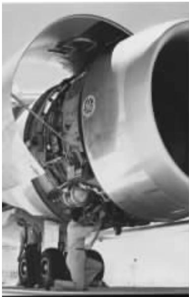
● 美国通用电气公司的涡轮发动机在地面检修
