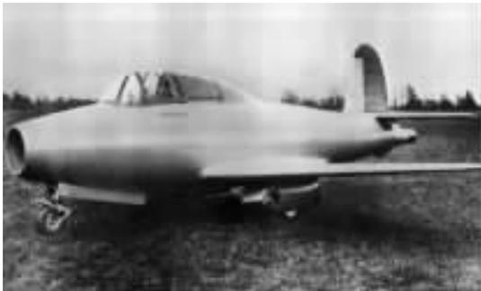
英国第一种涡轮喷气式飞机——E. 28/39
