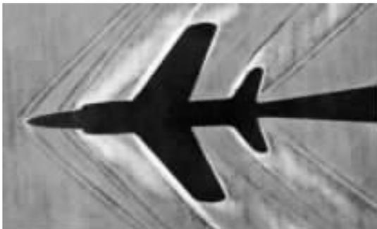
风洞试验中的激波影像
