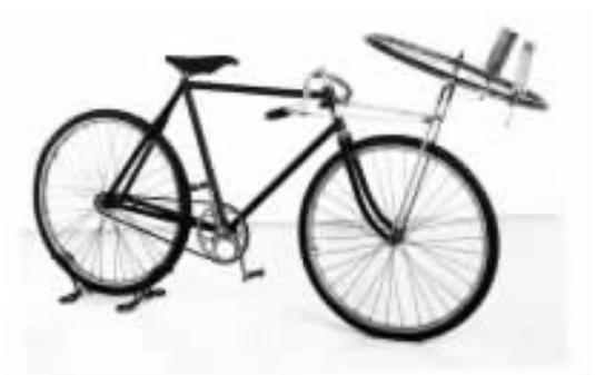
● 莱特兄弟利用自行车进行机翼翼型试验
