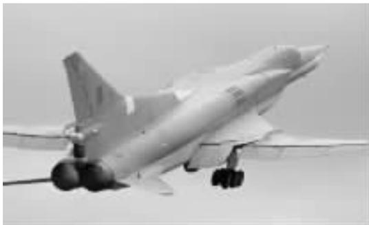
● 俄罗斯图-22M 轰炸机的后缘襟翼
