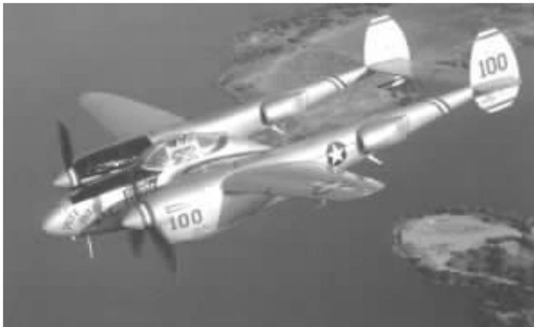
● 发动机使用涡轮增压器的 P-38 战斗机
