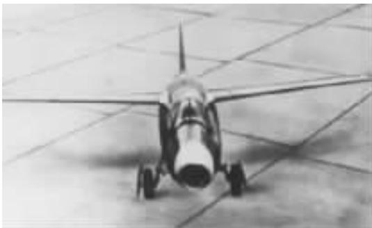
● 世界第一种涡轮喷气式飞机——德国的He. 178
