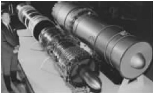
● 典型的涡轮喷气发动机
