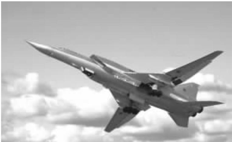
俄罗斯图-22M 超声速轰炸机的可变后掠翼
