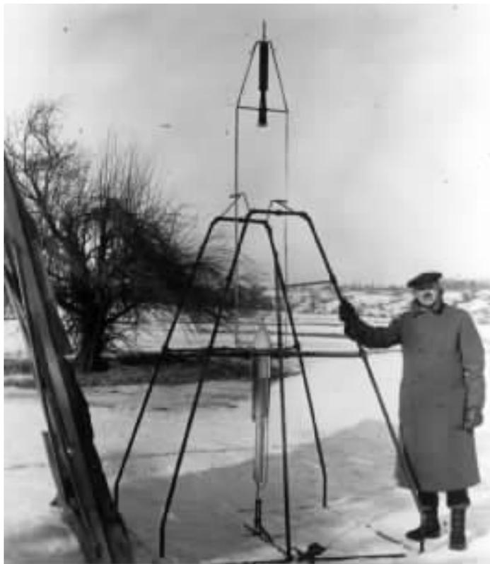
美国航天先驱戈达德和他设计的第一枚液体火箭。1926年春3月26日,戈达德和妻子以及两个助手在沃德农场进行了世界上第一枚液体火箭的发射试验。火箭总长约3米,顶部是0.6米长的发动机,它连接了两个推进剂贮箱,用两个长约1.5米的细管将液氧和汽油传送到燃烧室中,输送方式是高压氮气挤压法。点火后飞行2.5秒,上升高度12米,距离56米。虽然这枚火箭的性能并不理想,但它开创了人类航天的新纪元,打开了液体火箭技术的大门。
