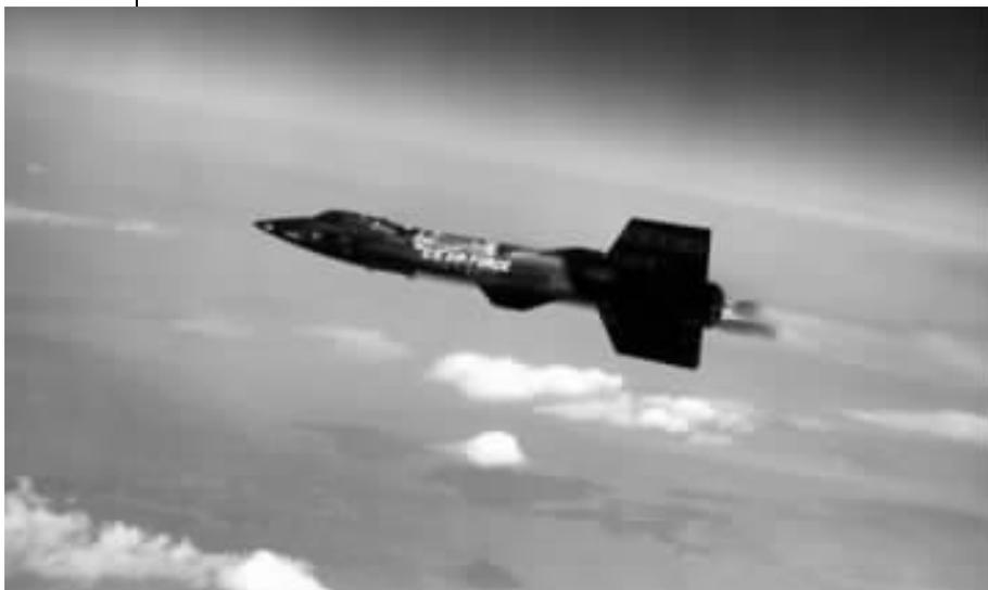
► 这是美国研制的 X - 15 高超声速火箭试验机。它虽然类似于普通飞机,但采用火箭动力,机身用高温合金制成,并安装了反作用控制系统,飞行员穿着类似于宇航员的服装,因此本质上更像一架航天器。它在 20 世纪 60 年代中期创造了最大速度,其马赫数(Ma)等于 6.72 最大高度 107.9 千米的纪录。
