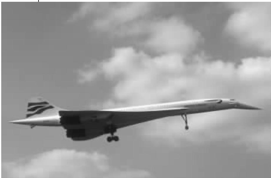
✎ 这是英法联合研制的“协和”式超声速运输机,1976年投入使用。“协和”号的设计在技术上是十分成功的,特别是在气动外形设计上首次利用了脱体涡型产生升力,导致了飞机空气动力学设计上的一场革命。但它在商业上却是个失败者,主要因为其经济性差,载客量小,航程短,噪音声染严重。2003年,英法两国先后作出决定中止“协和”号的一切商业飞行。
