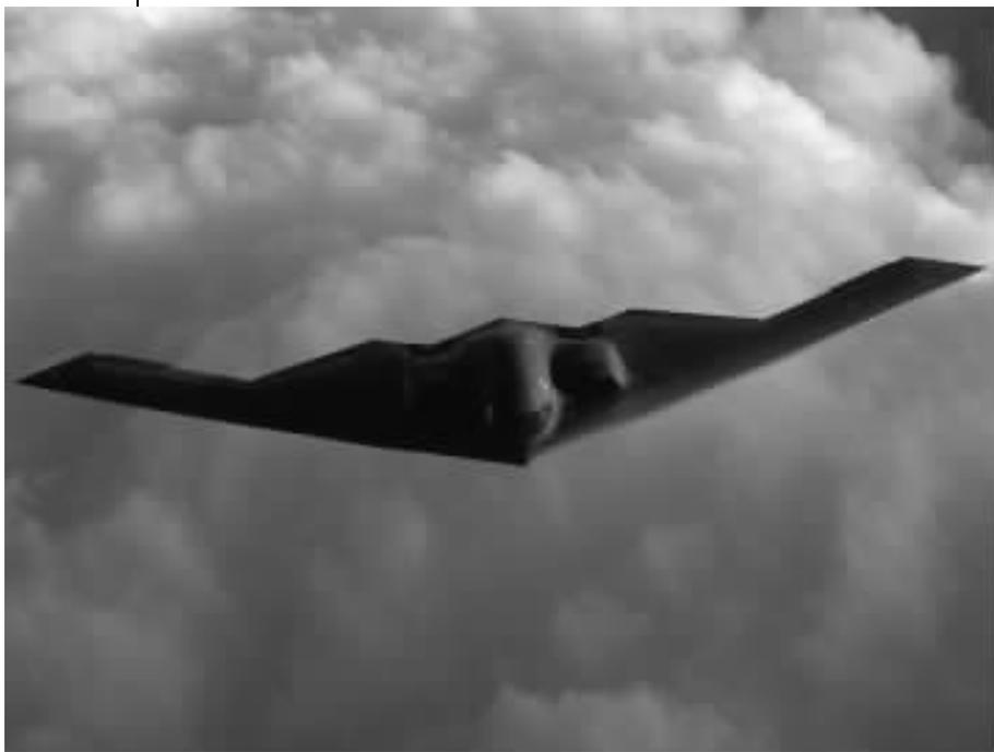
✈️ 这是美国的 B - 2 隐身战略轰炸机。它采用对隐身非常有利的飞翼式气动布局 ,外部没有任何外挂物。除气动隐身外 ,它还采用了多项红外隐身、材料吸波隐身等措施 ,从而使其隐身性能极佳。它在正常探测距离下的雷达散射截面积与一只大鸟相当 约 0.1 平方米。
