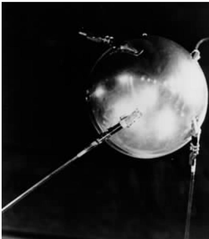
这是人类历史上第一颗人造地球卫星——苏联的“卫星”一号,1957年10月4日发射成功。它进入近地点215千米,远地点947千米,轨道倾角65度,周期96.2分的椭圆形轨道,在轨道上运行了92天,绕地球飞行约1400圈,于1958年1月4日再入大气层时烧毁。这颗卫星发射成功,标志着人类航天时代的到来。
