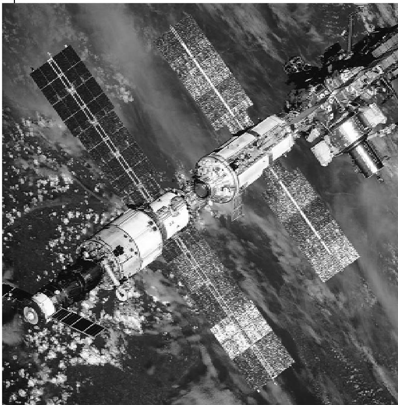
▶ 这是正在建设中的国际空间站,预计 2006 年建成。届时它将由 12 个舱段组成,总质量达 450 吨左右,使用空间达 1 100 立方米,平均运行高度 460 千米,寿命 15 年。它将成为人类在太空中长期逗留的一个前哨,可用于试验新型能源、运输技术、自动化技术和下一代遥感器,推动流体力学、燃烧学、生命保障系统、反辐射危害等研究的发展,并对未来的太空探索产生重要影响。
