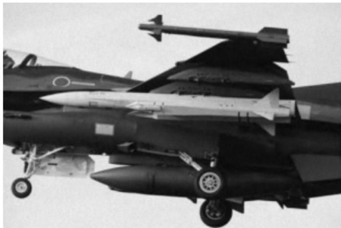
日本研发的新型反舰导弹ASM-3
