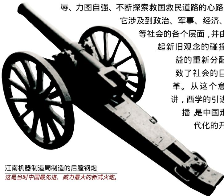
江南机器制造局制造的后膛钢炮
