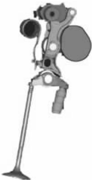
图 2-122 气门行程控制轴开始动作凸轮轴控制进气
