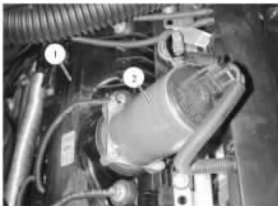
图 2-125 气门行程控制电动机
