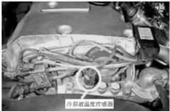
图 1-53 冷却液温度传感器
