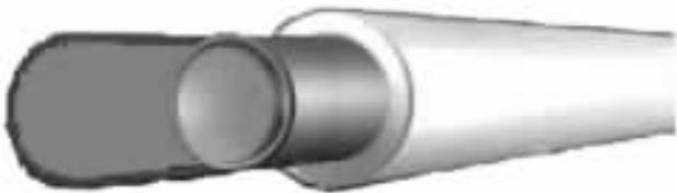
图 2-5 光纤结构
