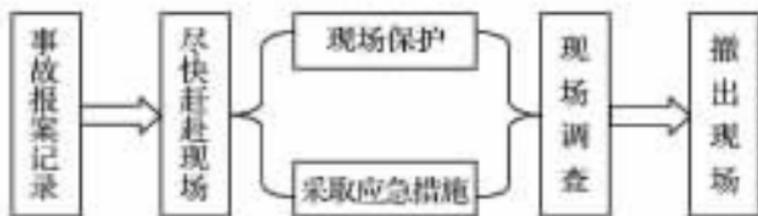
图 4 - 1 交通事故现场勘查的程序框图
