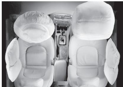
气囊膨胀后的情形
