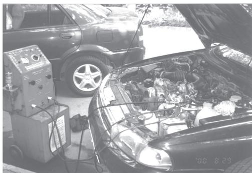
免拆清洗设备及清洗现场
