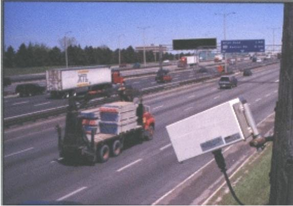
图 6.2 微波检测器
