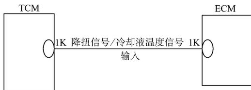
图 6-52 马自达 MX-6 及 626 型轿车降扭信号/发动机冷却液温度信号电路
