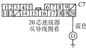
图 3-169 检查仪表板线束 20 芯连接器的 20 号接线柱 (+) 与地线之间的导通性
