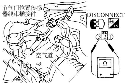
图 4-46 检查节气门位置传感器端子(2)与(3)的电阻值
