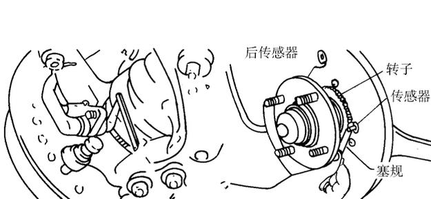
图 4 - 136 检查传感器与转子间的间隙
