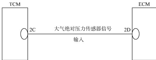
图 6-67 马自达 929 型轿车大气绝对压力传感器电路
