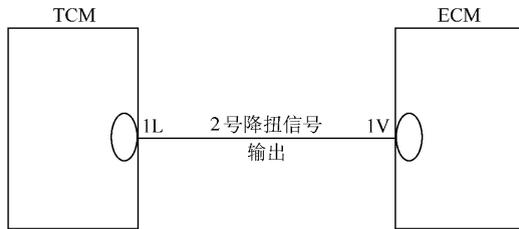
图 6-51 马自达 MX-6 及 626 型轿车 2 号降扭信号电路
