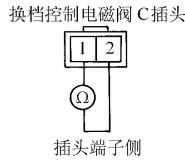
图 3-109 在电磁阀插头处测量换挡控制电磁阀 C 的电阻
