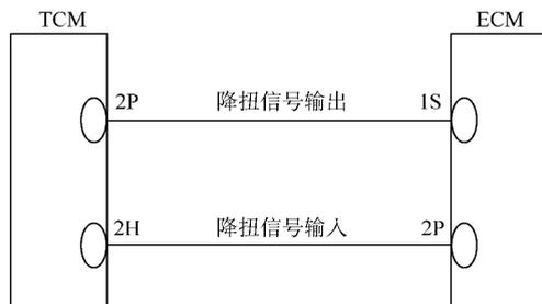
图 6-66 马自达 929 型轿车降扭信号电路
