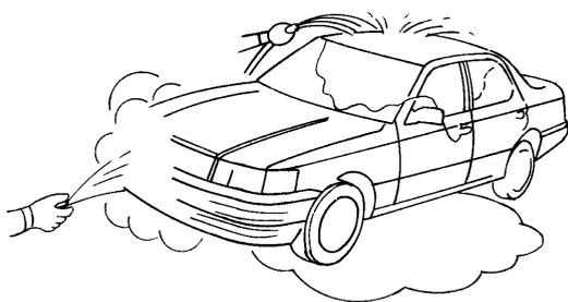
图 1-12 用水淋法模拟故障
