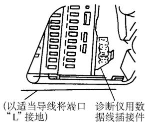
图 4-116 用导线将“诊断仪插接件”上的端口“L”接地
