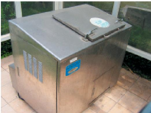
怎样优化选择堆肥设备、提供最佳的堆肥条件同样是垃圾堆肥过程中极其重要的工作内容。堆肥设备的类型繁多,小型柜式堆肥机、大型立式发酵仓、卧式堆肥滚筒等都是应用较多、效果良好的堆肥设备。堆肥条件主要是指:垃圾性状(含水率、粒度、空隙率、碳/氮比)、堆制温度、空气(氧气)流量和含量、搅拌或混合强度等。
