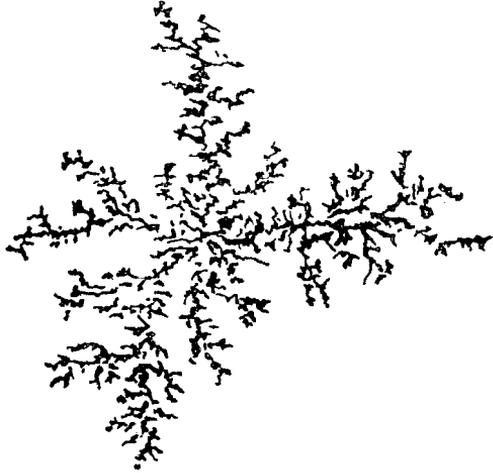
图 6-14 锌金属叶的分形结构
