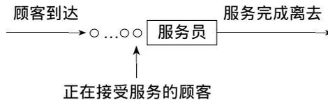
图 10.2 单服务员排队系统的图解表示
