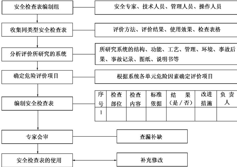
图 7-1 安全检查表的编制过程
