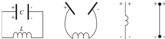
图 15 - 5 电磁波的发射
