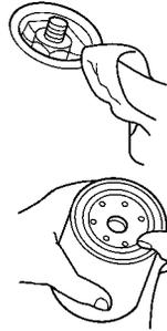
图 7-7 密封圈上涂机油
