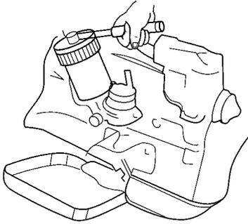
图 7-6 拆卸机油滤清器
