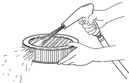
图 5-5 空气滤清器滤芯的维护
