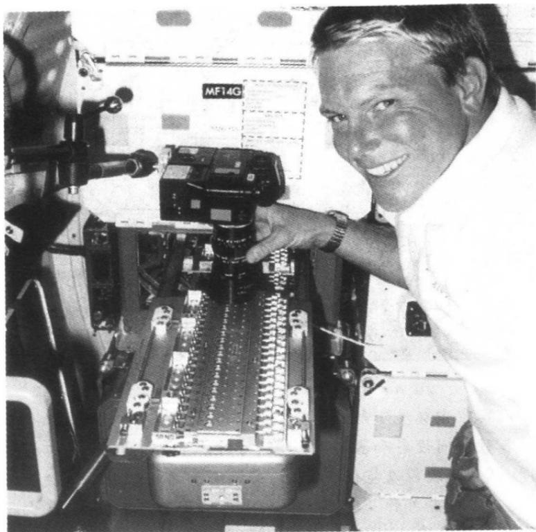
在太空中进行蛋白晶体生长实验
