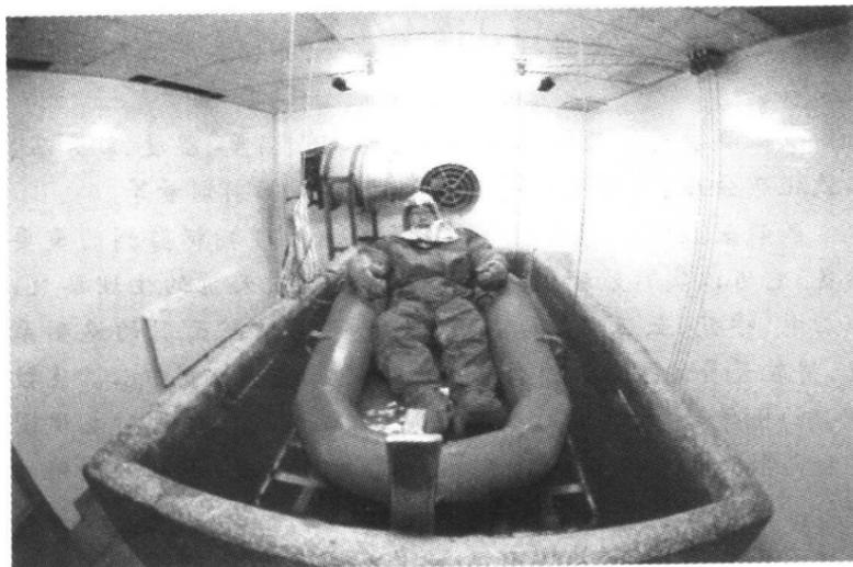
抗浸护寒服低温水浸泡试验
