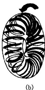
图 2-7 涡轮转动时的工作液流动路线
