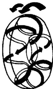
图 2-8 工作轮转速相同时工作液的流动路线
