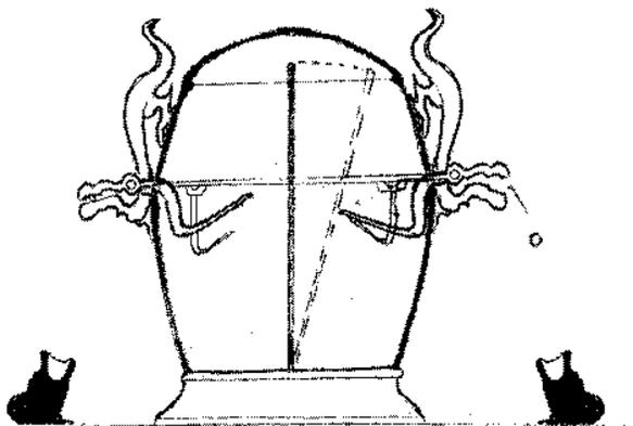
中间的柱子就会朝那个方向倒过去，触动机关，对着那个方向的龙嘴就会张开，铜球就“当”的一声掉进了蛤蟆嘴。张衡发明的这架地动仪是世界上第一架记录地震的仪器。”爷爷停了一下，拍着冬冬的头继续说：“冬冬，你一定要牢牢记住张衡这个名字。”
