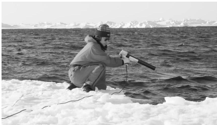
图 1-5 北冰洋调查观测海水温度
