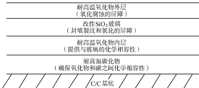
图 5 - 45 1800 以上长寿命 C/C 抗氧化涂层的理想涂层系统
