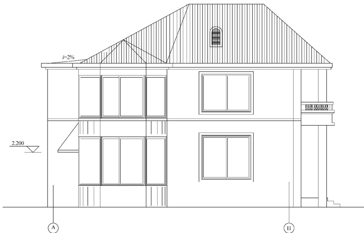
图 1-1-7 某二层住宅侧A~II轴立面图
