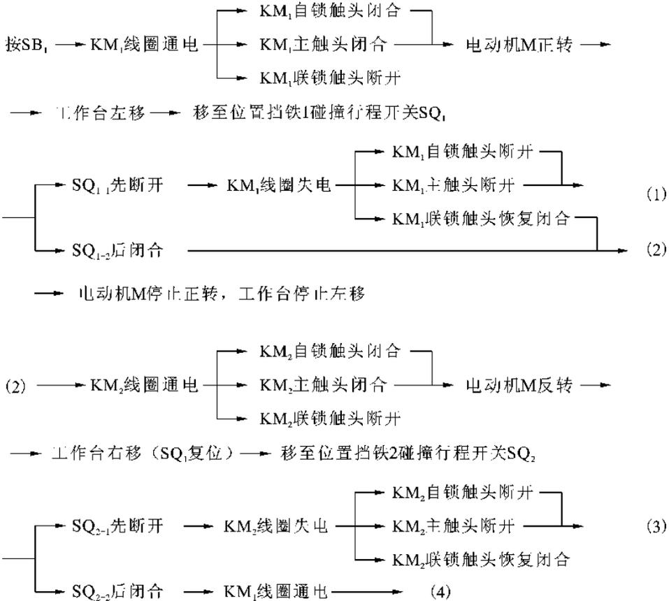
(3) → 电动机M停止反转, 工作台停止右移
