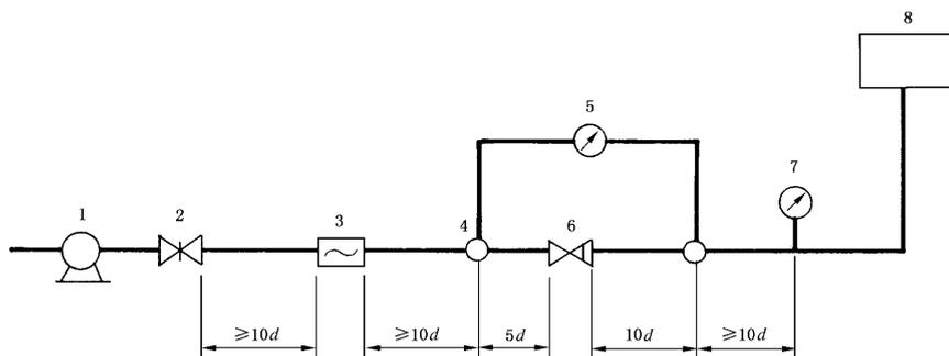
1—泵；2—闸阀；3—流量计；4—测压孔；5—压差测量装置；
