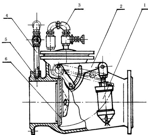
1—缓闭装置;2—扇形臂和连杆;3—阀后补气装置;
